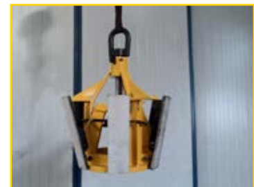
Hijsklem ten behoeve van rollen Lifting clamp for rolls
