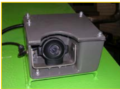
Camera behuizing voor beweegbare camera Camera housing for movable camera
