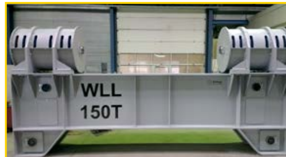
Hijframe WLL-150T L=6mtr Lifting frame WLL-150T L=6 m
