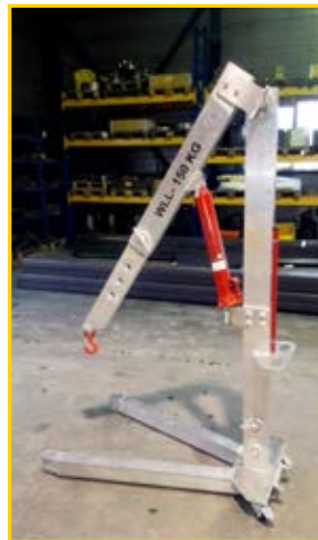
Aluminium werkplaatskraan, maatwerk Aluminium workshop crane, custom
