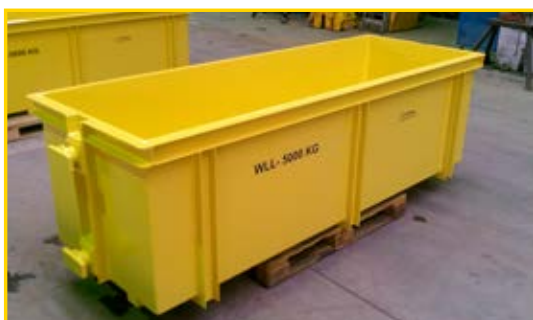
Schrootbak (staalschroot) kantelbaar Charging box (steel scrap), tilting
