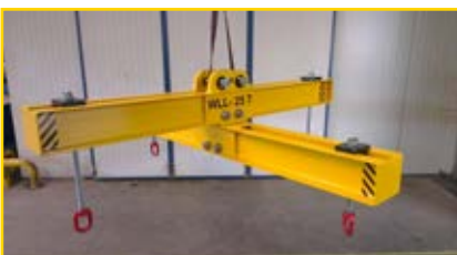
Hijstraverse 4 punts draaibaar, verstelbaar Rotatable 4-point lifting beam, adjustable
