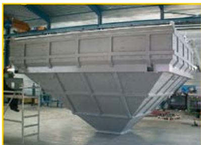
Stort trechter Unloading hopper
