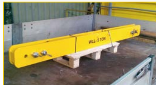
Lage bouw hijstraverse WLL-5T Low profile lifting beam WLL-5T
