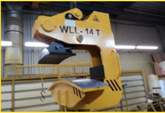
Hijsklem ten behoeve van windmolenbladen Lifting clamp for windmill blades
