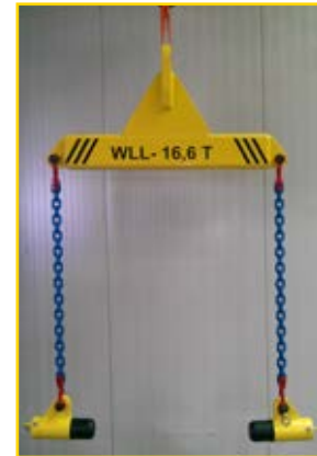
Hijsjuk met hijsassen ten behoeve van spoel Lifting beam with lifting bars for coil
