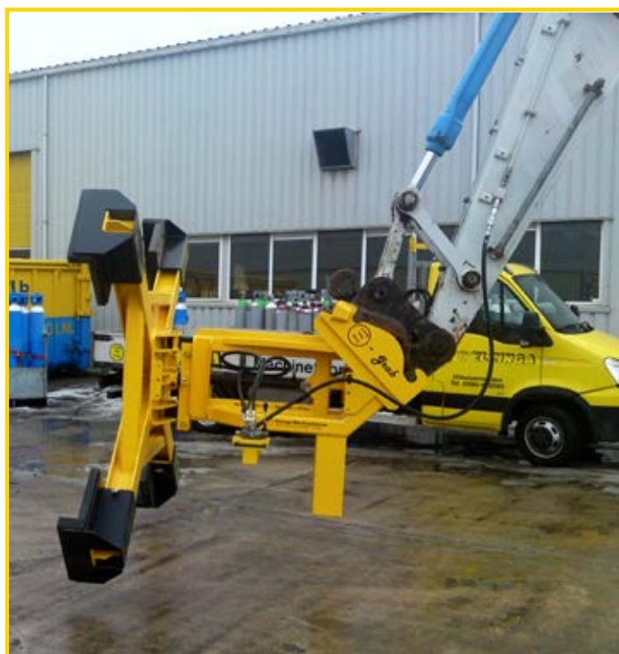
Koelwaterleiding (ø2500mm) montagehulpstuk Cool water pipe (ø2500 mm) mounting piece
